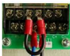
Рис. 3.3.3-3 (Соедините соответствующие разъемы при помощи короткого провода)
